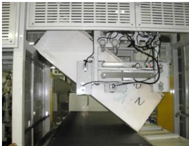
従来ライン：吸着移載時に落下した様子 (斜めに傾いてコンベアに接触し停止)
