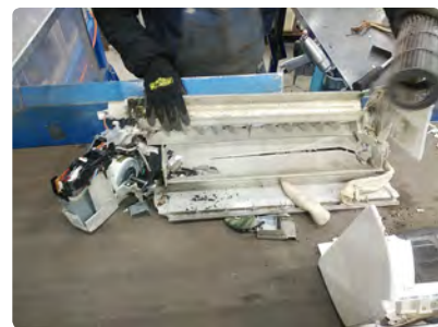
切断後の手解体作業
