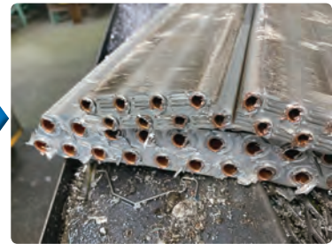
切断後の断面
