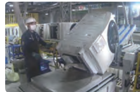
3) 作業台（昇降式）を降下する
