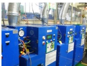
イソブタン・冷凍機油処理装置
