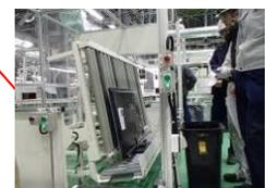
薄型TV投入補助装置(垂直)
