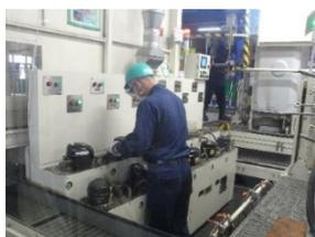
コンプレッサーを専用排気装置にセット
