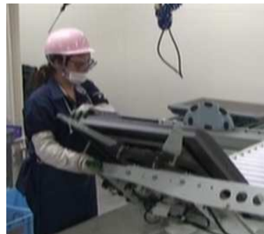
写真2： 薄型テレビを作業台に置く際、作業台に投入する工程を機械化したことで、薄型テレビを安全に搬送、解体することが可能となった（特許出願中）
