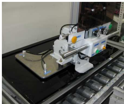
写真2： 薄型テレビを作業台に置く際、作業台に投入する工程を機械化したことで、薄型テレビを安全に搬送、解体することが可能となった（特許出願中）
