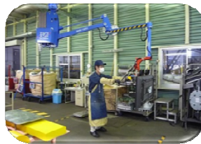
改善後。移載装置を導入し重量物を機械搬送するよう改良した
