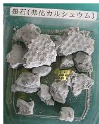
生成されたフッ化カルシウム
