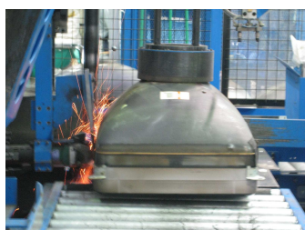
防爆バンドが機械により 除去されている様子
