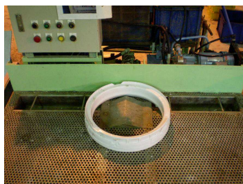
洗濯機の塩水リングを 破断している様子
