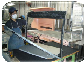
改善前。蛍光管ユニットと前面キャビネットを作業者が手で分離している様子
