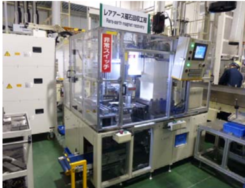
自動解体装置全景
