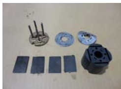
③ローター解体
