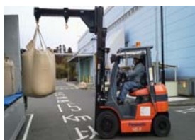
吊り込みアタッチメントの開発
