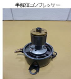
①半解体コンプレッサーから ローターを分離・単品化
