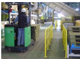
歩行者安全柵の設置
