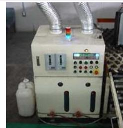
炭化水素冷媒・冷凍機油処理装置
