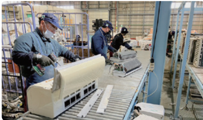
エアコン解体ライン
