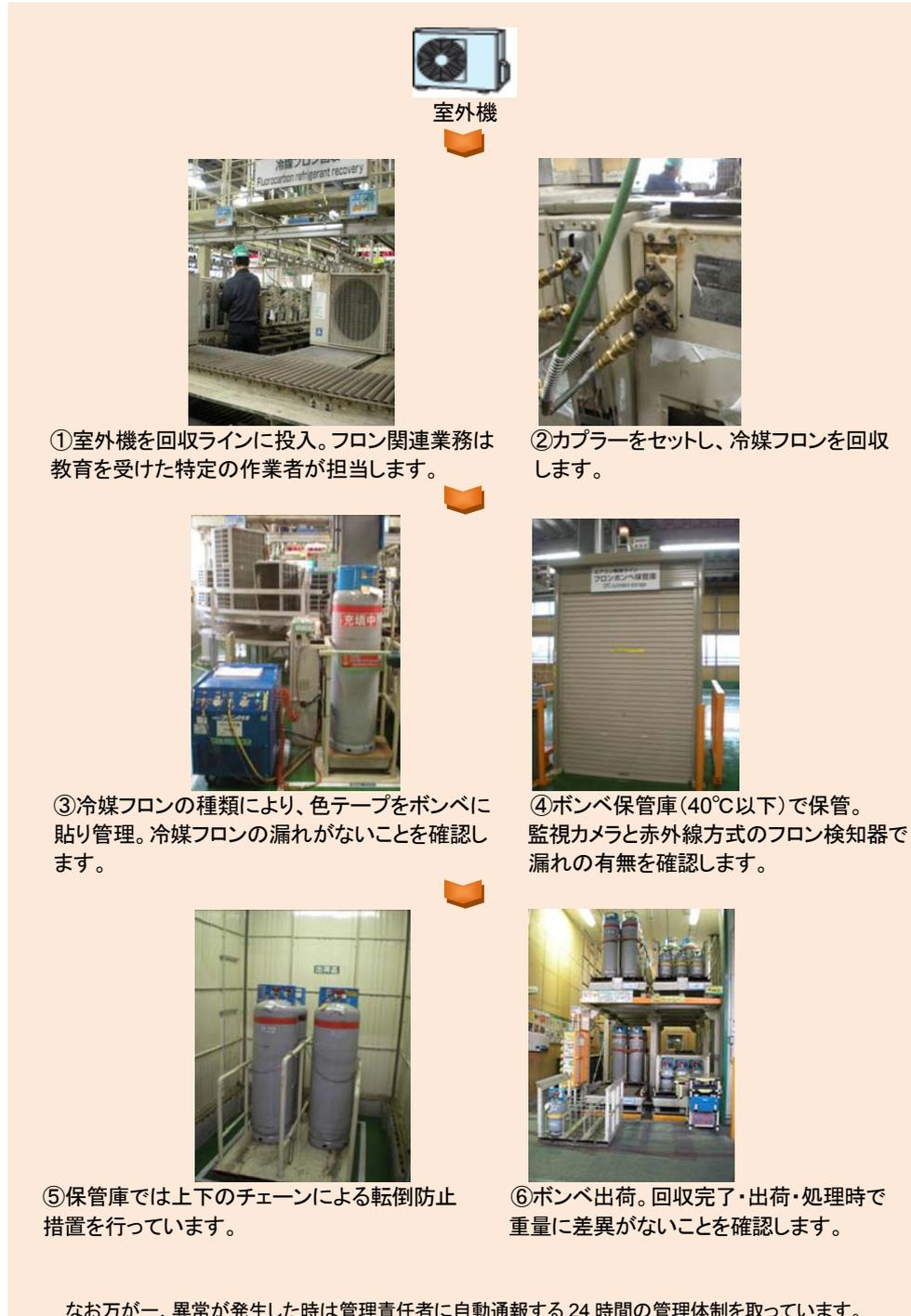
(2) 冷蔵庫・冷凍庫の冷媒・断熱材フロンの代表的な回収・管理フロー
