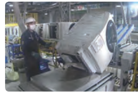
3) 作業台（昇降式）を降下する
