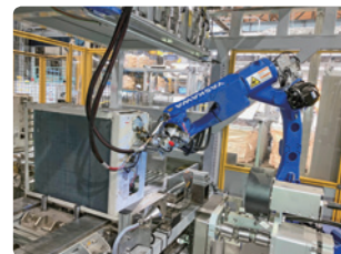
フロン自動回収システム
