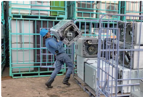
図1 人力によるコンテナ積載作業
