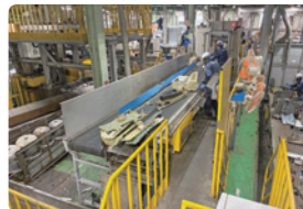
室内機自動搬送
