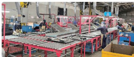
薄型テレビ解体ライン
