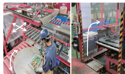
専用セル解体作業台 投入装置（傾転）
